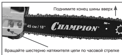
Рис. 5 Регулировка натяжения цепи
